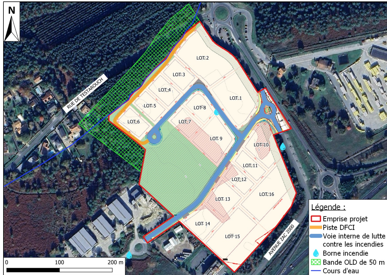
Figure 123 : Défense incendie du secteur et du projet (Source : Volet VRD – ADDEXIA ; Réalisation : CERAG)
