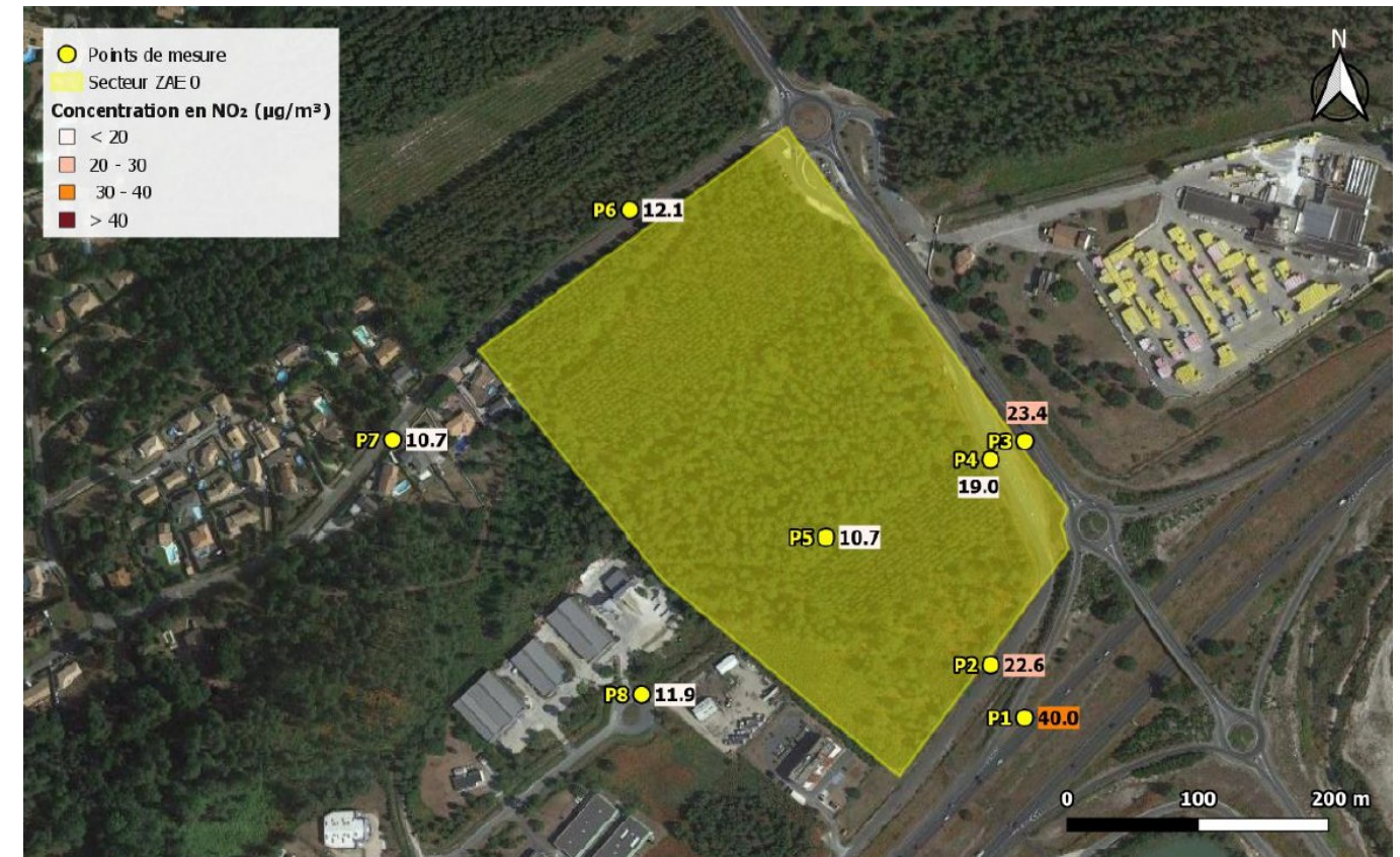
Figure 84 : Localisation des points de mesure de la qualité de l'air et cartographie des résultats (Source : Etude Air et Santé – RINCENT AIR)
